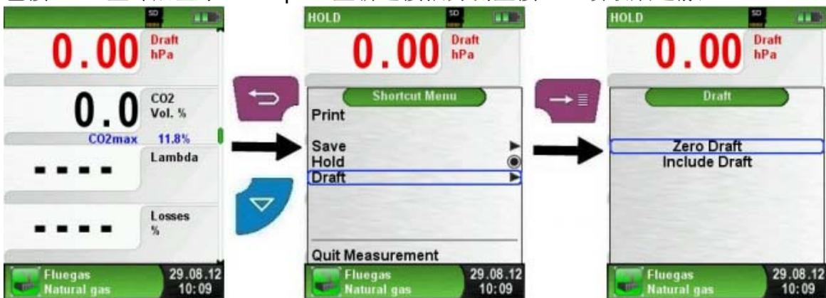
压力的测量值会在主界面上连续实时地显示（红色字体）。在选择“记录压力”后，测量值将会存入测量记录中，并以黑色字体显示。
