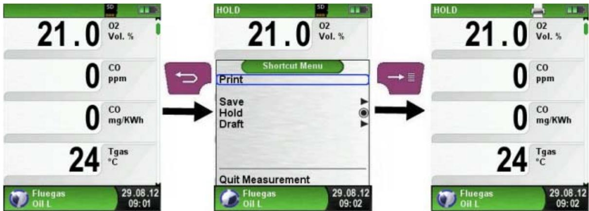
可以在打印之前先查验锁定模式下的测量数据。也可以在稍后的时间打印已经被锁定的测量值（这是测量数据已被锁定功能临时的存储）。一旦执行打印命令，实时的测量数据就会打印出来，而测量工作还在正常进行（即多任务处理模式）。
