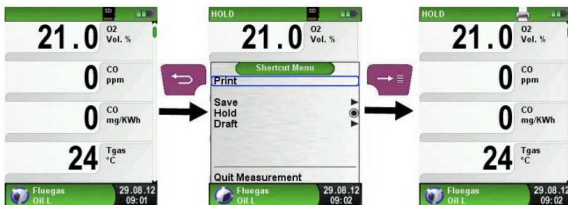
图 6：直接存储菜单（例：烟气测量）
